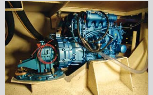
La propulsion mécanique est assurée par deux moteurs Nanni Diesel hybrides, un diesel de 60 ch et une génératrice électrique de 7 kW.
