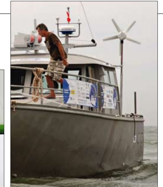
Deux éoliennes Ce grand cerf-volant, réalisé par Omega Sails, dispose d'un bord d'attaque gonflable qui facilite l'envol. Deux éoliennes complètent la charge des batteries, effectuée par le moteur hybride ou les panneaux photovoltaïques.
