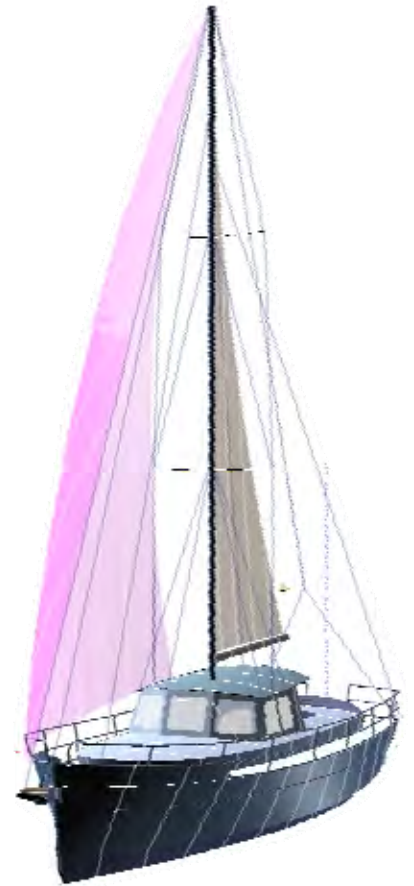
vue 3/4 avant avec annexe sur pont arrière et Reacher déroulé. Surface voilure = 104 m 2
