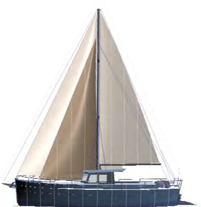
Vue latérale avec annexe sur pont arrière et Gènois + trinquette. Surface voilure = 109 m 2
